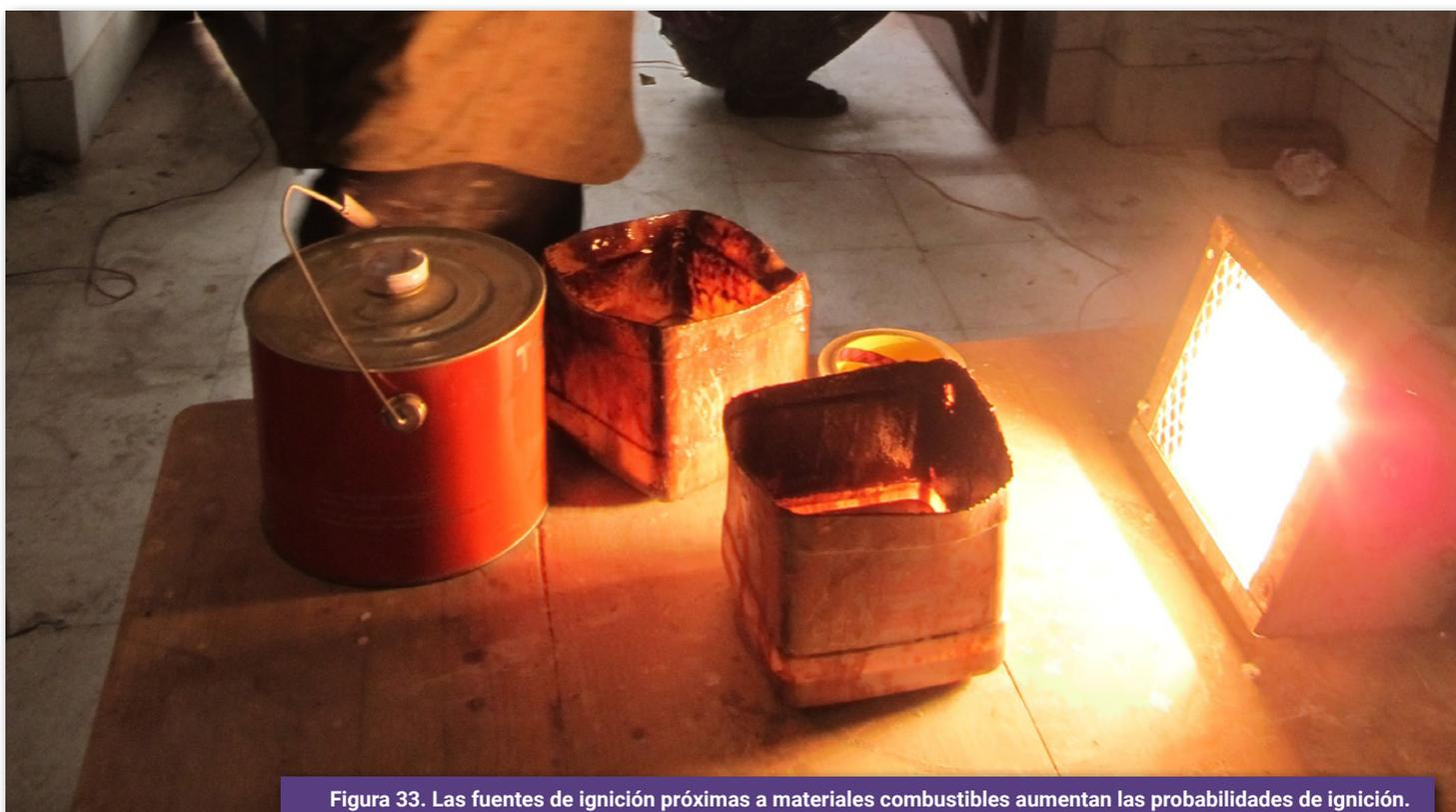
Figura 33. Las fuentes de ignición próximas a materiales combustibles aumentan las probabilidades de ignición.
